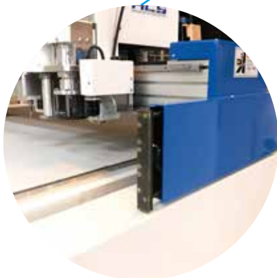
Khi có chướng ngại vật đi vào khu vực cắt, các cảm biến an toàn sẽ làm cho máy dừng lại.
