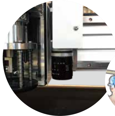
Hệ thống nhận dạng dấu cắt cho phép vừa cắt hiệu chỉnh, vừa cắt tự động.
