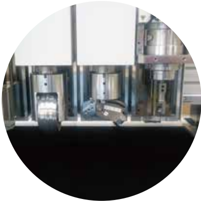
Đa dụng cụ có thể lắp tối đa bốn (4) dụng cụ.
