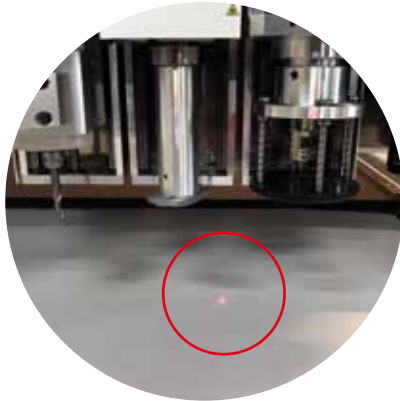
Đèn Laser theo dõi các đường cắt.
