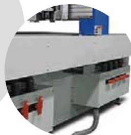
Theo kích thước của vật liệu, khu vực hút chân không có thể được điều chỉnh bằng chức năng phân chia khu vực chân không. (tùy chọn)
